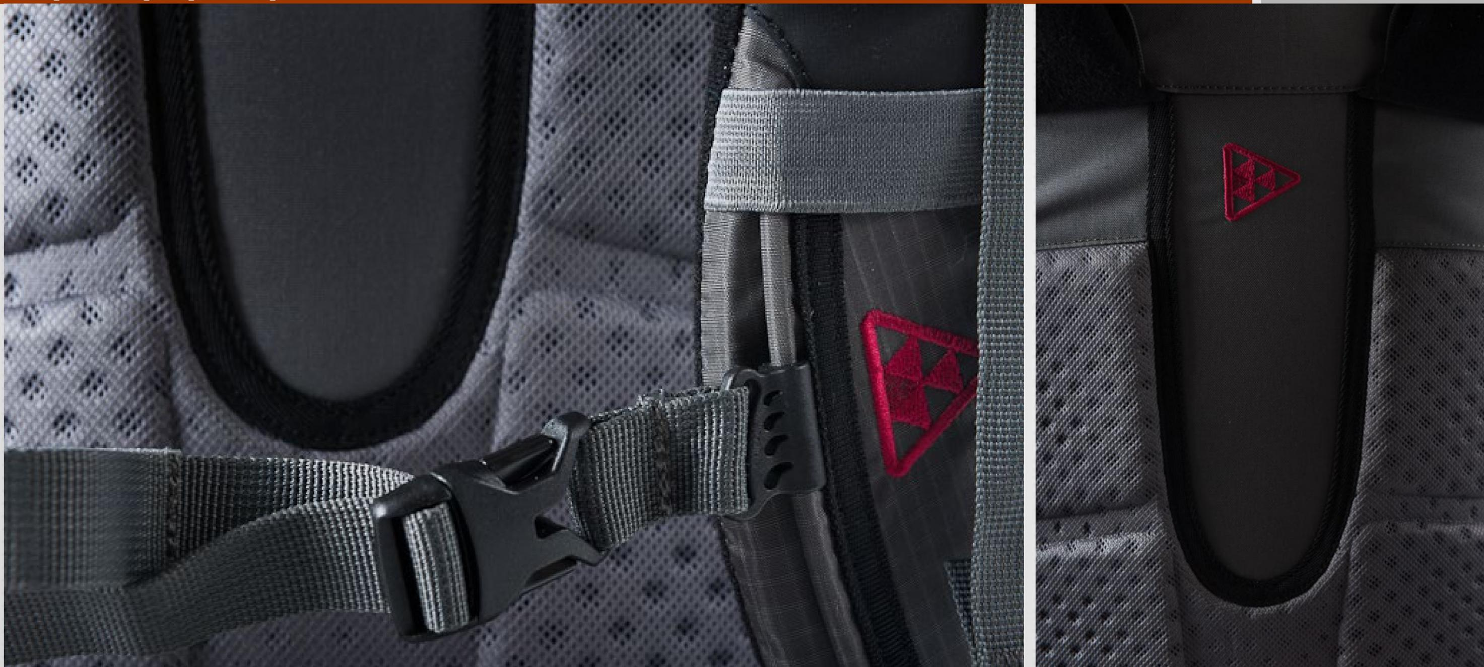
Спина рюкзака термоформирована специальным образом так, что при использовании обеспечивается хорошая вентиляция. Перфорация в «пенке» спинки, коврика и лямок выполнена не насквозь, а на 2/3 толщины. С одной стороны уменьшен вес, с другой – не нарушены тепловые свойства пенополиуретана.
